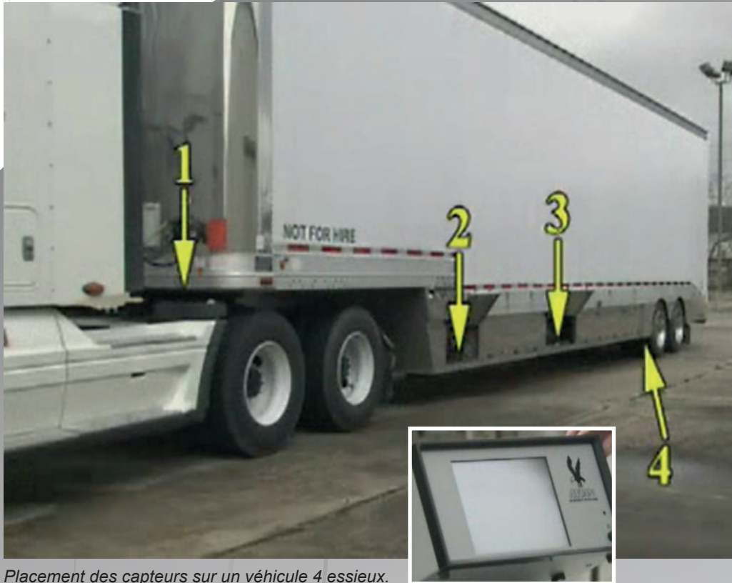
Placement des capteurs sur un véhicule 4 essieux.
